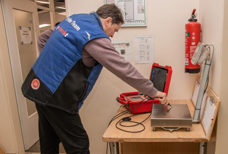
Prüfung von Elektrogeräten nach DIN VDE 0701 und 0702
