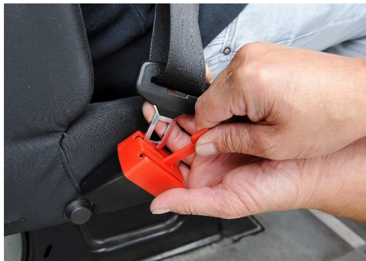
© Ledder Werkstätten gGmbH, 2023: Geschlossenes und geöffnetes Gurtschloss
